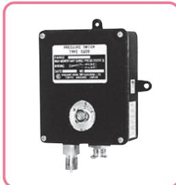
感圧エレメントにブルドン管を使用し、このブルドン管の動きにより、マイクロスイッチを直接動作させて回路をON-OFFするものです。耐振性にすぐれ、現場形として直接、機器に取り付けて使用することができます。
