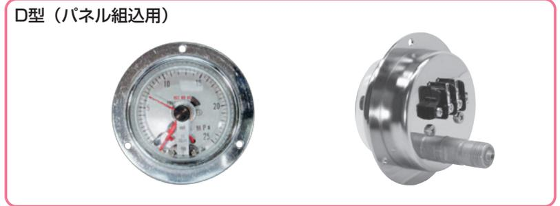
本品はブザー又はベルによる警報、パイロットランプの点滅、などのON-OFF制御する場合に用います。指示目盛を持っていますので指示計器としての役目も果たし安全監視に合理的な運転管理計器に適しています。
