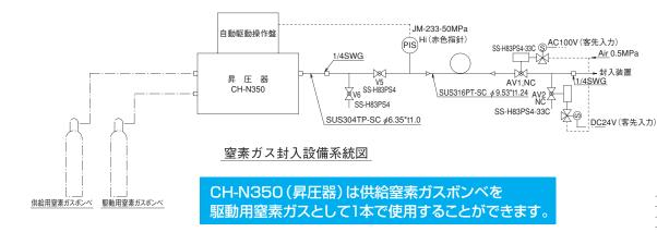
設計条件 設計圧力: 35MPa 常用圧力: 25MPa 設計温度: 40℃
