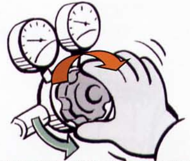
圧力調整ハンドルを操作して最高使用圧力まで上がるか確認する。
